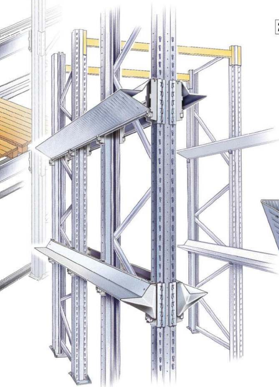
21 Profilo guida DRIVE-IN bidirezionale con staffa singola
