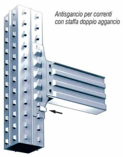
Per un corretto montaggio sono indispensabili ed obbligatori i ganci di sicurezza. Il dispositivo antisgancio impedisce il distacco accidentale del corrente dal montante in caso di urto; inoltre nei correnti con staffa applicata o rivettata migliora notevolmente l'efficienza della connessione con il montante, svolgendo una funzione strutturale.
